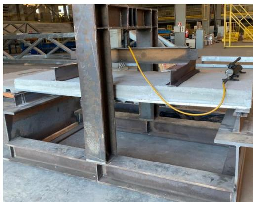
Para a realização do ensaio efetivo, foram moldados seis protótipos a fim de verificar a capacidade de carregamento. Eles foram
