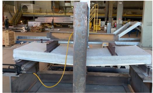
Nesta fase de início do ensaio, observa-se que o deslizamento relativo de extremidade é nulo, ou seja, a interação entre a forma de
