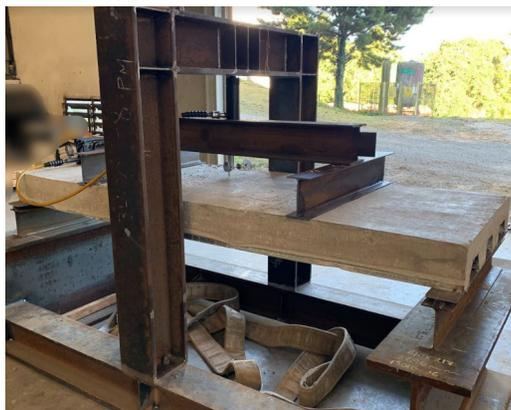
Após o início da aplicação de carga, dois momentos foram observados: aquele em que ocorreu a acomodação do concreto na forma, e o rompimento. Ambos foram anotados e tiveram seus resultados pré-analisados.
